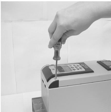
3.Opening the Soft-Start Abriendo el arrancador suave SSW-06 Abrindo a Soft-Start
