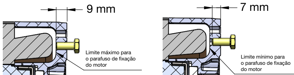
Figura 38 - Límite de profundidad del engaste
