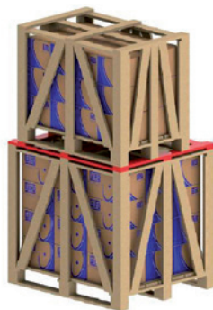
Figura 30 - Utilización de varas adicionales para apilamiento
