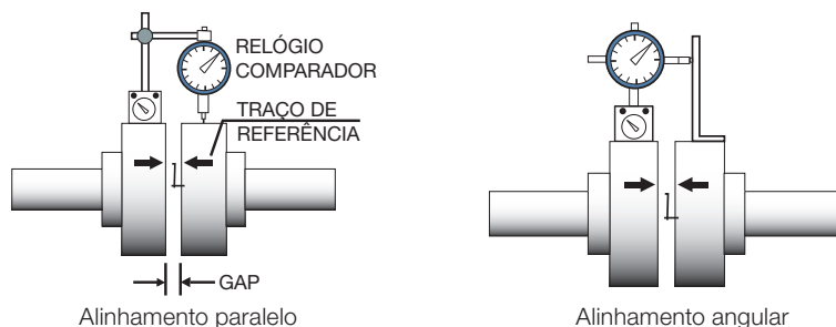
Figura 6.11 - Alinhamento com relógio comparador
