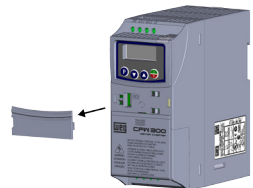
(a) Removal of the communication accessory cover (a) Remoción de la tapa de accesorios de comunicación (a) Remoção da tampa de acessórios de comunicação
