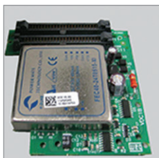
(a) Placa Eletrônica VDCx
