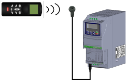
Figure A.2: Communication with remote control Figura A.2: Comunicación con el control remoto Figura A.2: Comunicação com o controle remoto
