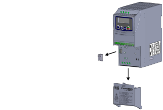
(a) Removal of the accessory and connection protection covers (XC4) from the IO expansion (a) Remoción de las tapas de accesorios y de protección de la conexión (XC4) de la expansión de IO's (a) Remoção das tampas de acessórios e de proteção da conexão (XC4) da expansão de IO's
