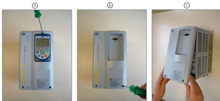
Figura 2: Remoção da tampa frontal
