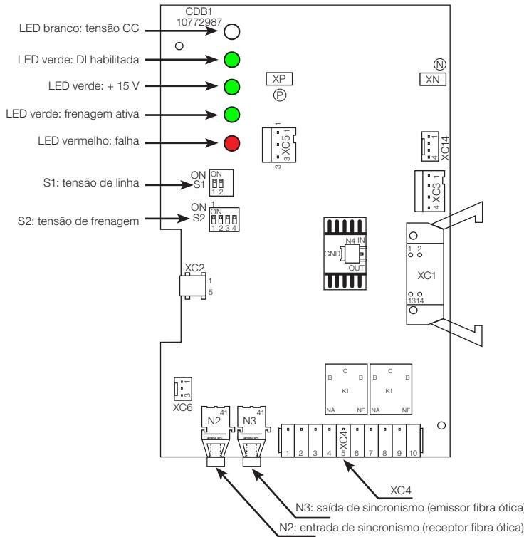
**Figura 3.7:** Pontos de conexão do cartão CDB1
