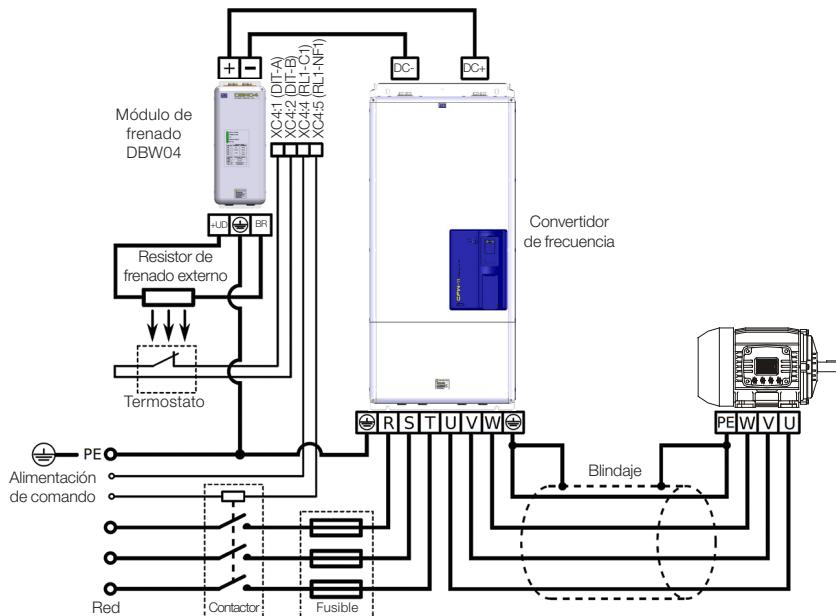
Figura 3.5: Ejemplo de circuito básico de aplicación
