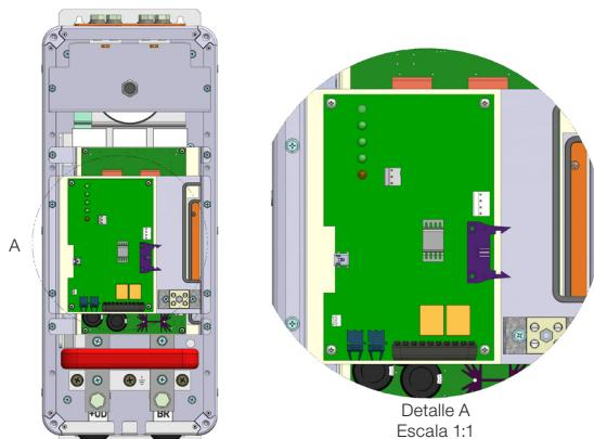
Figura 3.6: Localización de la tarjeta de control CDB1
