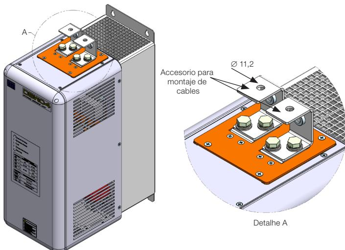
*Figura 3.2: Accesorio para el montaje de cables en las conexiones "+UD" y "-UD"*
