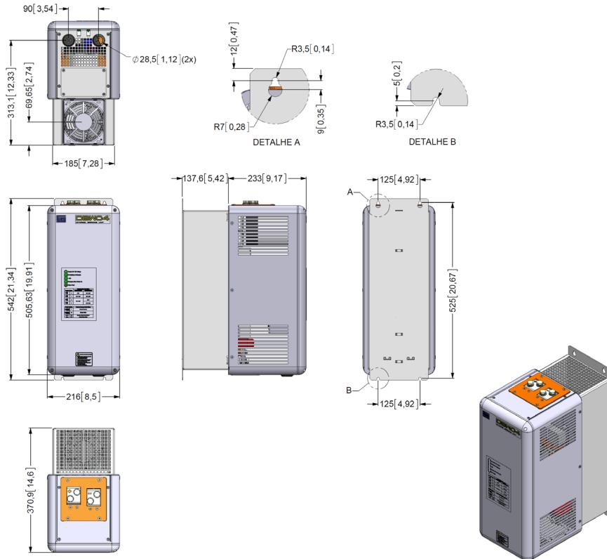
Figura 7.1: Dimensões do DBW04 em mm [in]
