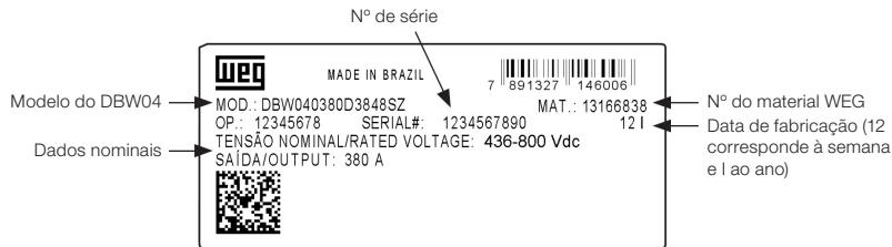
*Figura 2.5: Exemplo de etiqueta de identificação do DBW04*
