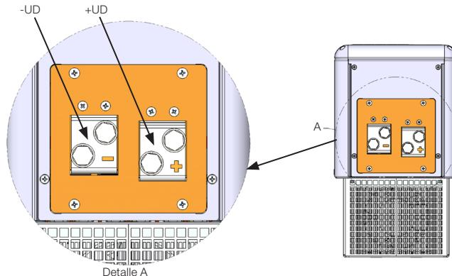
*Figura 3.3: Conexiones de entrada +UD y -UD*
