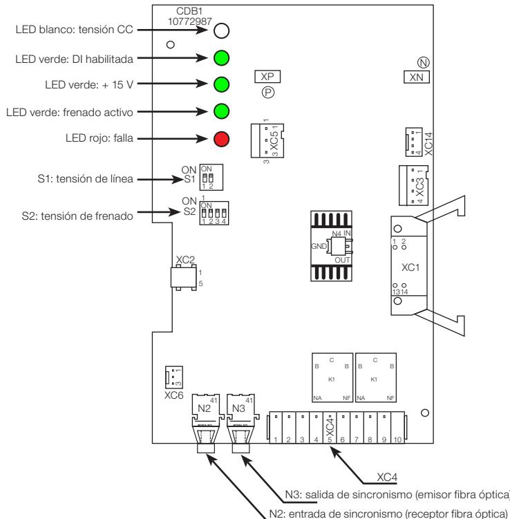
Figura 3.7: Puntos de conexión de la tarjeta CDB1
