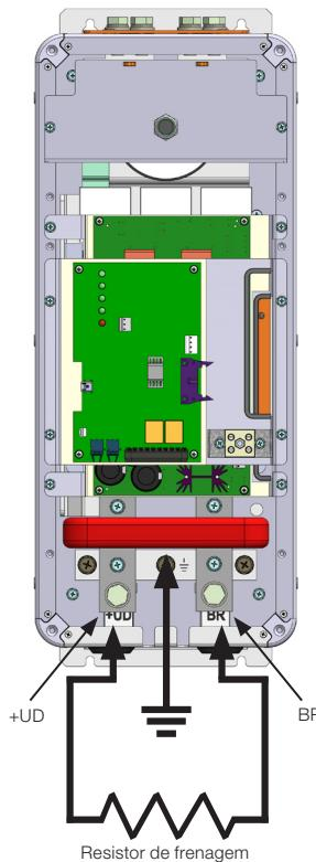
**Figura 3.4:** Conexões do resistor de frenagem e aterramento
