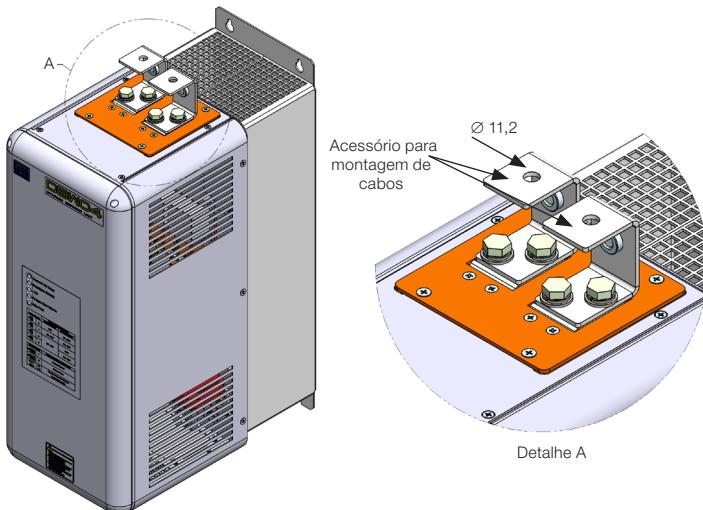
*Figura 3.2: Acessório para a montagem de cabos nas conexões "+UD" e "-UD"*
