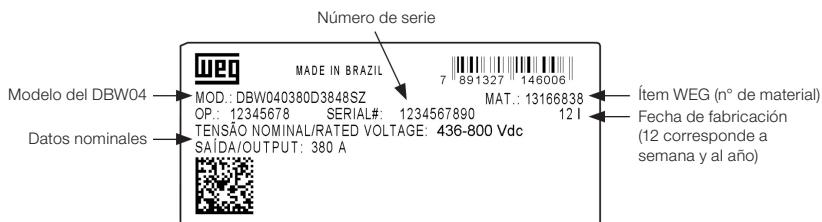
*Figura 2.5: Ejemplo de etiqueta de identificación del DBW04*
