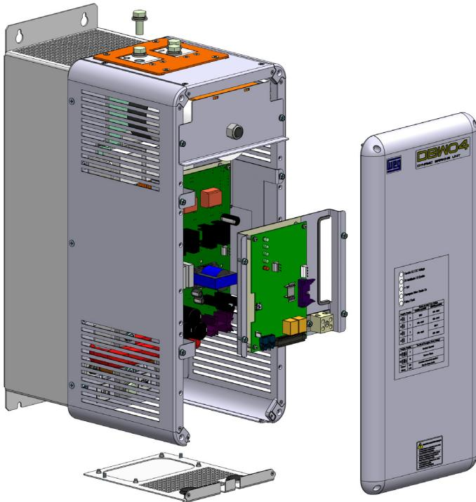
*Figura 2.4: Principales componentes del módulo de frenado DBW04*
