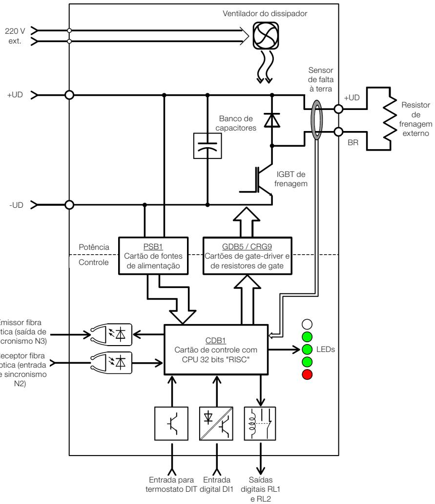
Figura 2.3: Esquema geral do módulo
