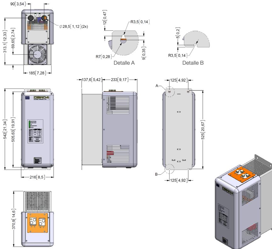
Figura 7.1: Dimensiones del DBW04 en mm
