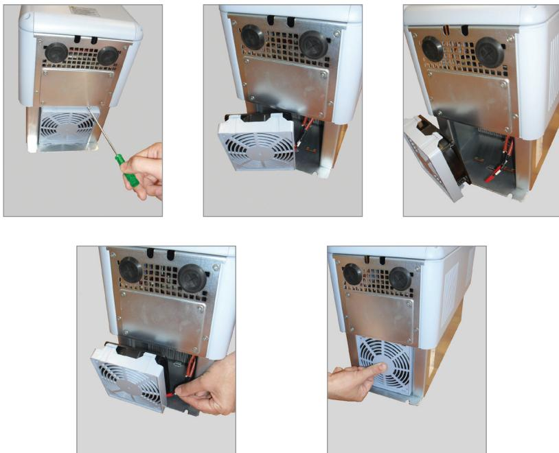
Figura 5.1: Cambio del ventilador
