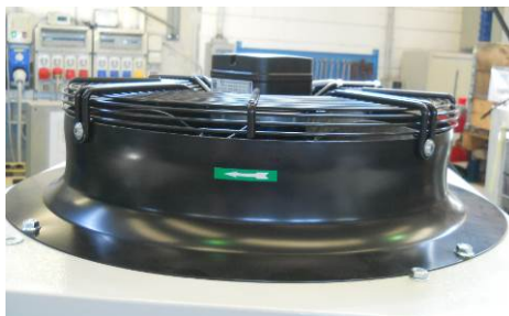
Figura 20 – Esempio di direzione di rotazione del ventilatore
