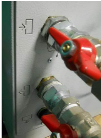
Abbildung 12 – Anschluss der Schläuche
