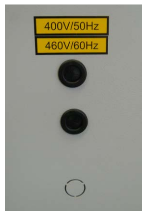
Figura 4 – Piastra per i collegamenti elettrici
