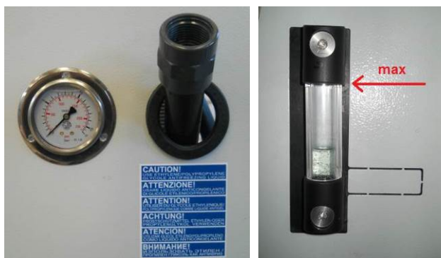
Figura 10 / 11 – Procedura di riempimento e livello massimo
