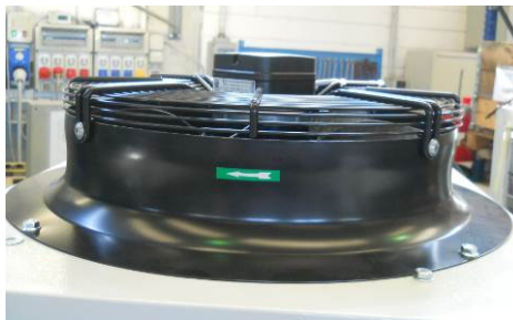
Abbildung 20 – Drehrichtung des Lüfters (Beispiel)
