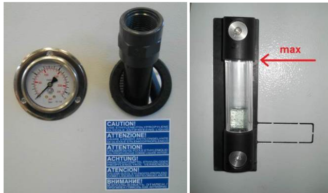
Abbildung 10 / 11 – Befüllverfahren und Höchststand
